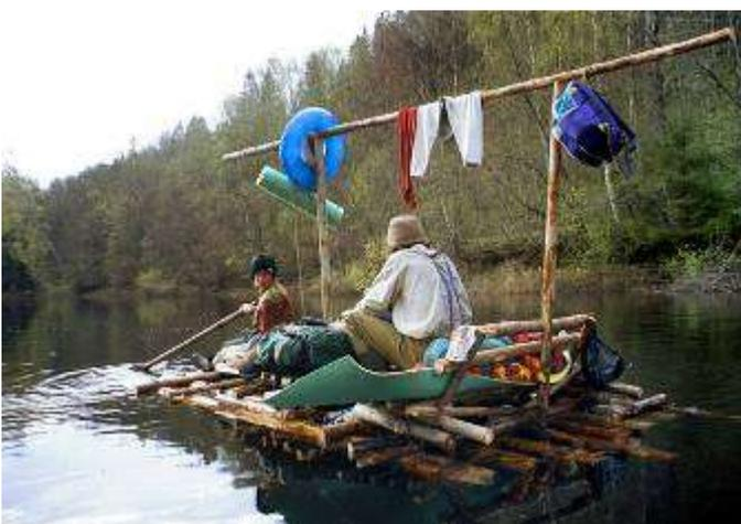
на берег реки строить плот. Десять одинаковых ровных брёвен по три метра крепко связывали между собой и пропитывали смолой. В непромокаемые мешки складывали необходимые вещи и продукты.
